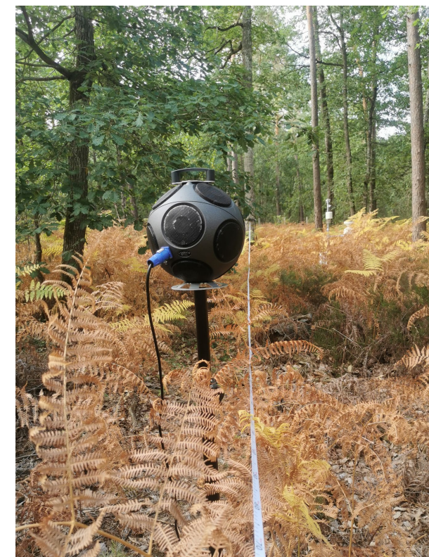
Source de bruit calibrée omni-directionnelle utilisée pour mesurer la propagation sonore
